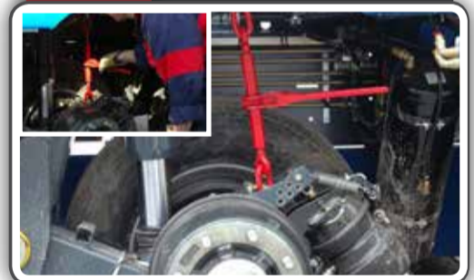
12 Zakken wiel op grond met kettingspanner
