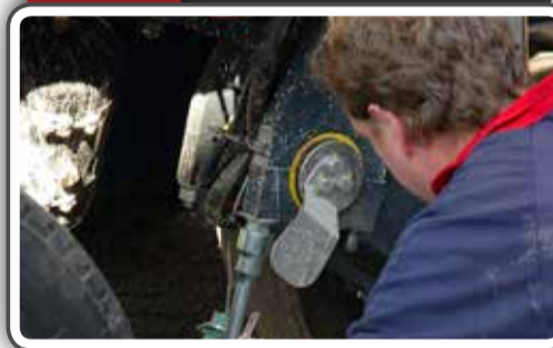
27 Aandraaien voorste moeren asknie (250Nm)
