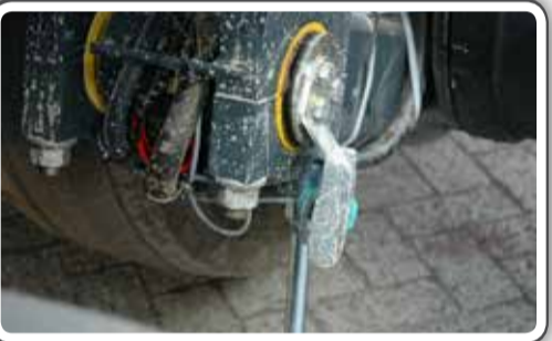
29 Aandraaien achterste moeren asknie (250Nm)
