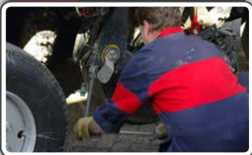
13 Verwijderen voorste moeren asknie
