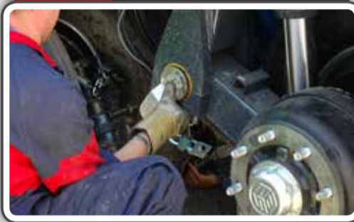
26 Plaatsen en bevestigen aszadels
