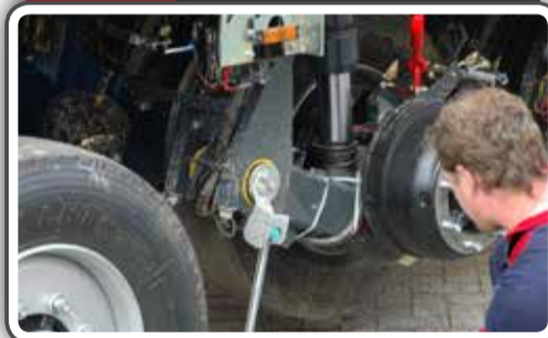
11 Verwijderen achterste moeren asknie
