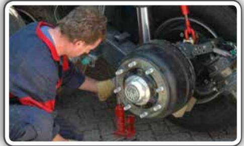
**29** Serrer les écrous arrière de la rotule de l'essieu (250Nm)
