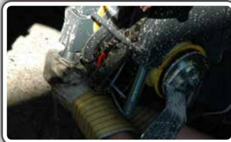
**15** Dégager la rotule de sous le coude de l'essieu avec le tendeur de chaîne
