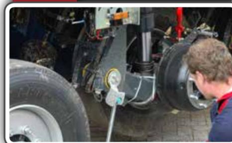
**12** Abaisser la roue au niveau du sol avec le tendeur de chaîne
