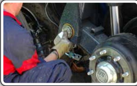
**27** Serrer les écrous avant de la rotule de l'essieu (250Nm)
