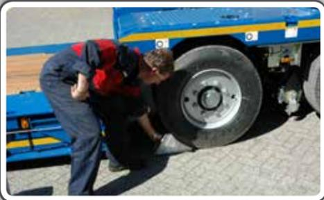
**38** Monter la suspension jusqu'à la position route
