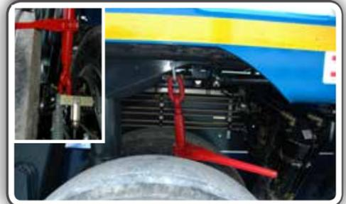
**9** Monter la suspension au niveau maximum
