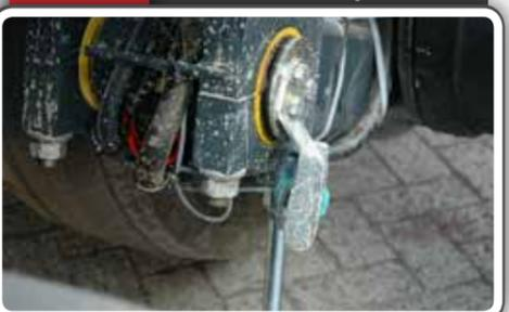
**30** Insertar de nuevo el mazo de manguitos detrás del codo del eje
