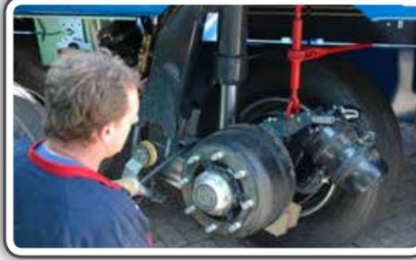
**24** Wagenheber unter Achse platzieren
